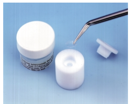
写真2. サンプルが注入されたテフロン製チェンバーに丸く裁断済みのメンブレンをセット
