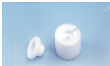
写真1. バイオダイライザーのテフロン製チェンバーにサンプルを注入
